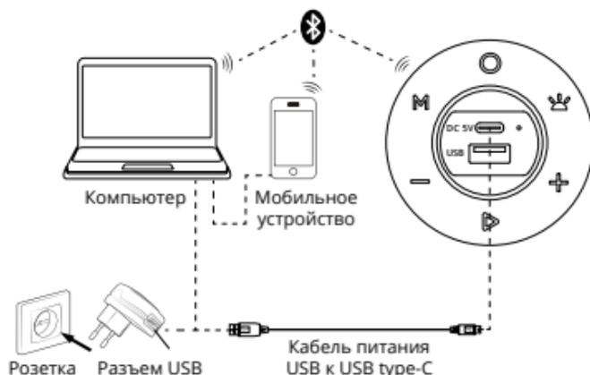
Рис. 2. Схема подключения
