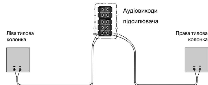
**Примітка.** Перевірте відповідність полярності підключення і відсутність контакту оголених проводів між собою і з металевими частинами апаратури.
