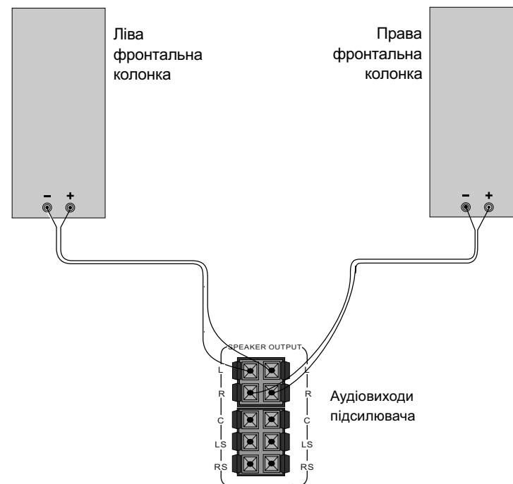
*Примітка. Перевірте відповідність полярності підключення і відсутність контакту оголених проводів між собою і з металевими частинами апаратури.*
