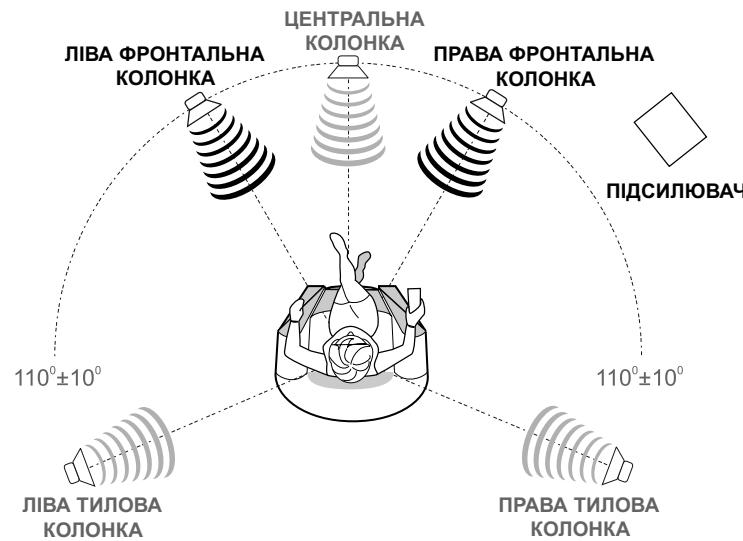
Для отримання якнайкращого результату при прослуховуванні відстань між головою слухача і кожною з колонок повинна бути однаковою і приблизно дорівнювати відстані між колонками. Розмістіть фронтальні АС справа і зліва від позиції прослуховування. Високочастотні динаміки фронтальних акустичних систем повинні перебувати на рівні вуха слухача. Оси фронтальних акустичних систем повинні перетинатися перед лицем слухача.
