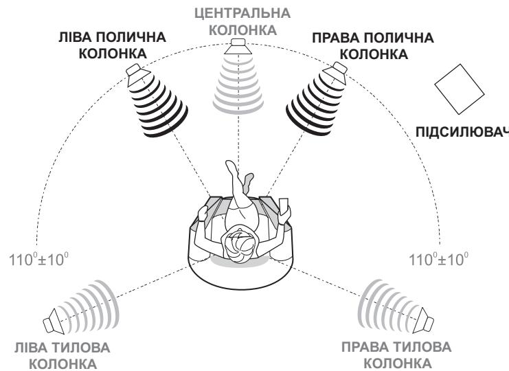
Для отримання якнайкращого результату при прослуховуванні відстань між головою слухача і кожною з колонок повинна бути однаковою і приблизно дорівнювати відстані між колонками. Розмістіть полічні (фронтальні) АС справа і зліва від позиції прослуховування. Високочастотні динаміки полічних (фронтальних) акустичних систем повинні перебувати на рівні вуха слухача. Оси фронтальних акустичних систем повинні перетинатися перед лицем слухача.
