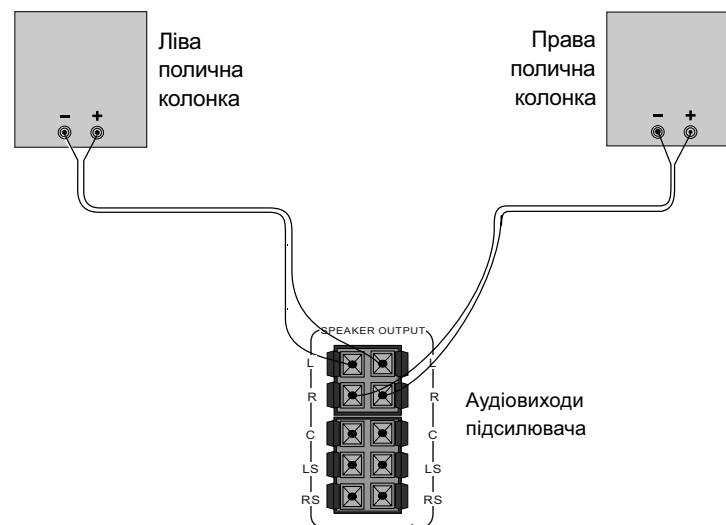
**Примітка.** Перевірте відповідність полярності підключення і відсутність контакту оголених проводів між собою і з металевими частинами апаратури.
