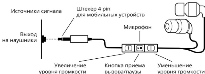
Рис. 1. Схема подключения
