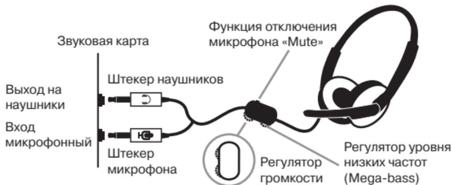
Рис. 1. Схема подключения
