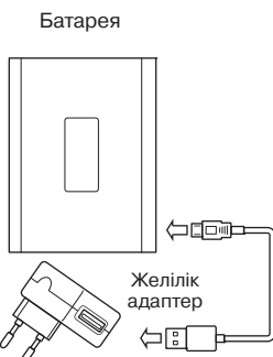
3-сур. Батареяның желілік адаптерден зарядталуы
